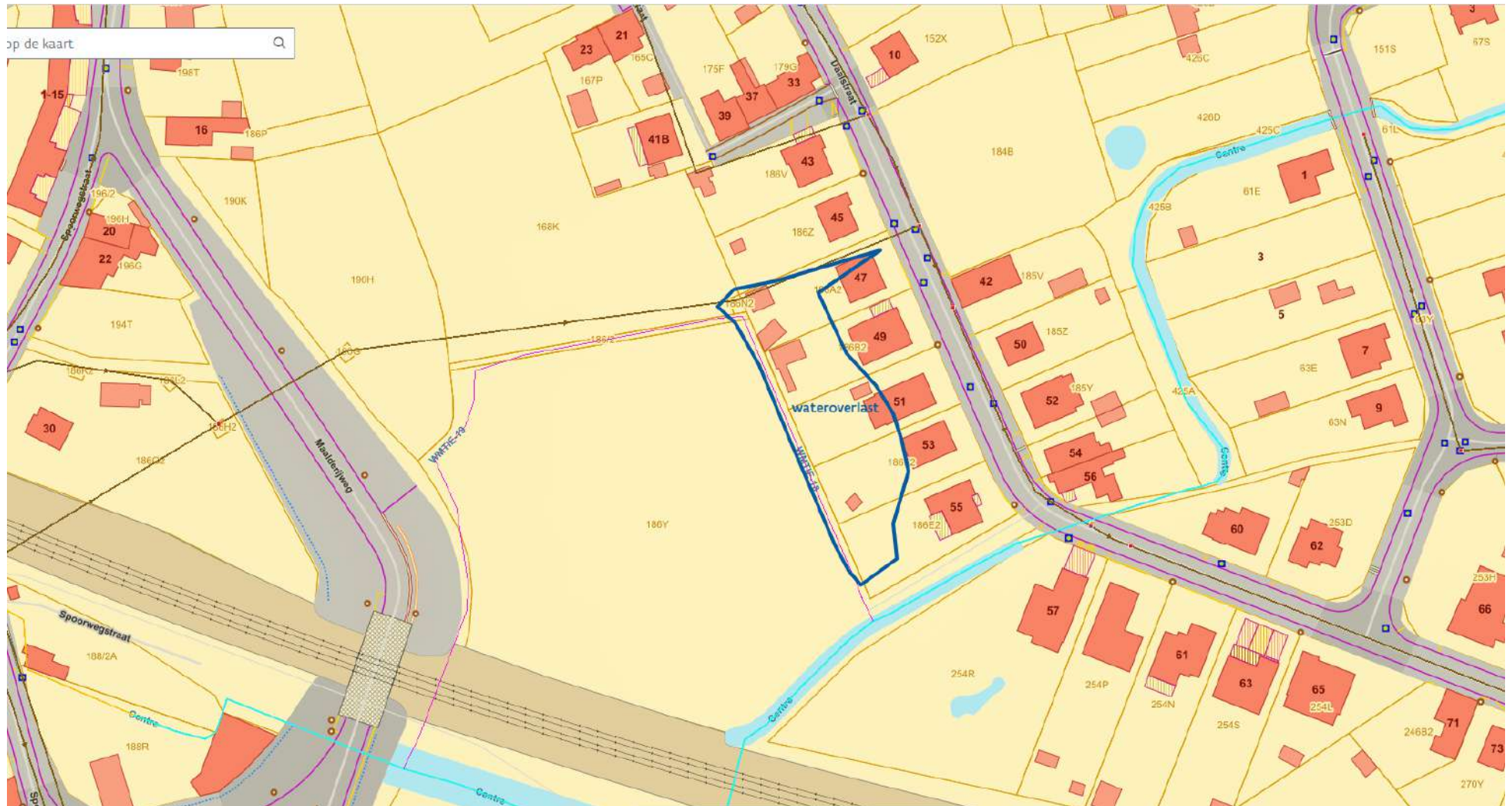
Kaart 4: wateroverlast in de Daalstraat vanuit het rioleringsstelsel
